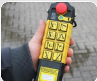
Der Gießarm lässt sich bequem per Funksteuerung bedienen
