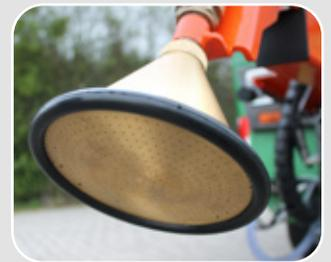
Mit der PowerJet-Düse kann der Wasserstrahl manuell eingestellt werden. Der Benutzer kann zwischen Punktstrahl, Kegelstrahl und Nebel wählen.
