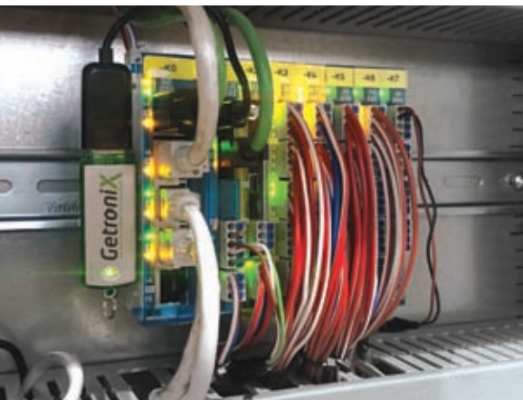
Oben: Als steuerungstechnisches Herzstück der runderneuterten Schlagschere fungiert nun ein kompakter »S-Dias«-Modulblock, der sich aus Standard- und Safety-CPU sowie digitalen, analogen sowie sicheren I/O-Modulen zusammensetzt. Ganz links zu sehen der USB-Stick für die von Getronix entwickelte Endlos-Datenaufzeichnungs-Lösung.
