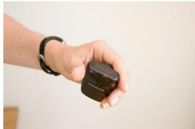
Die Funktion des Sensors wird durch automatische Selbsttests geprüft. Im Falle eines Stromausfalls wird mit Hilfe einer internen Stützbatterie ein Alarm gesendet.
