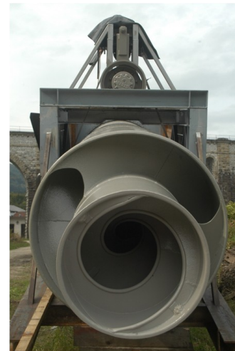
Abb. 32: Drehrohr-Doppel-Wasserkraftschnecke (Quelle: Fa. Hydroconnect)
