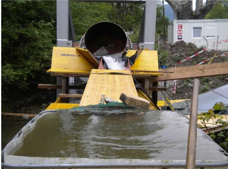
Abb. 2 - FAH Ausstieg mit fluderartiger Rinne in das Auffangbecken
