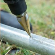
Die Mantelfläche des Handlaufrohres mit einem 12-mm-Bohrer durchbohren.
