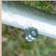
Die beiden Plättchen einzeln, mit der Krümmung voran, durch die Bohrung bis auf Anschlag in das Rohrinne schieben.
