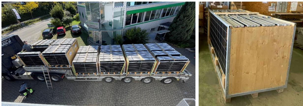
Abbildung 9: Anlieferung in FAST PV Transportboxen
