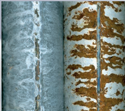
Magnelis® ZM120 feuerverzinkt Z275 geschweißt, nicht nachbehandelt zyklischer Korrosionstest (3CT) (VDA 621-415) nach einem Testzeitraum von 33 Wochen
