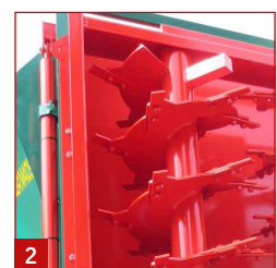
1. Stauwandsicherung 2. M Streuer mit 2 Walzenstreuwerk
