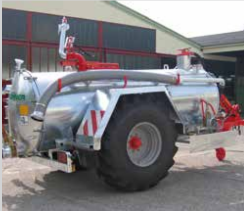
Stahlfass mit System KH und bodenschonender Sonderbereifung
