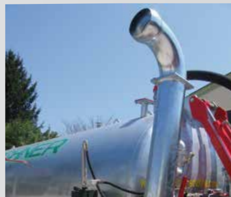
Vollhydraulisch justierbares Ansaugrohr mit automatischer Entlüftung
