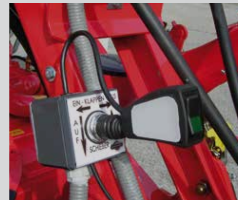
Joysticksteuerung als ideale Ergänzung für das Ansteuern eines Güllewerfers
