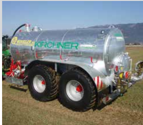
Tandem-Stahlfass mit System KK und bodenschonender Sonderbereifung
