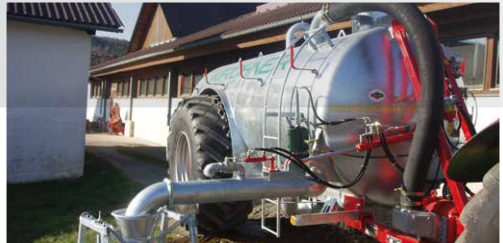
Pump-Stahlfass mit hydraulisch justierbarem Ansaugrohr
