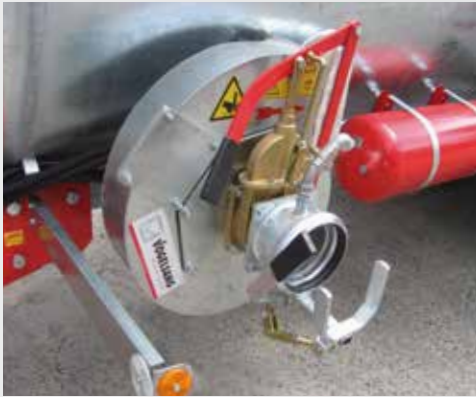
POWER FILL: Hydraulisch angetriebene Kreiselpumpe als Fassfüllhilfe für schnelleres Ansaugen
