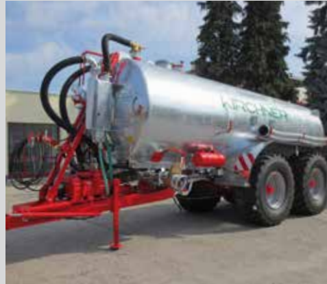
Tandem-Stahlfass mit System KK , Zwangslenkung und Deichselfederung
