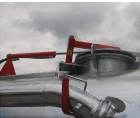
Hydraulischer Domdeckel mit intelligentem Schließmechanismus
