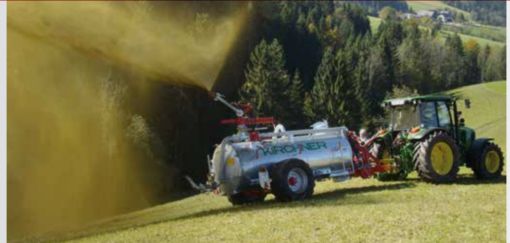
Stahlfass mit System KH und Güllewerfer. Für alpines Gebiet mit tiefem Schwerpunkt: die gekröpfte Achse
