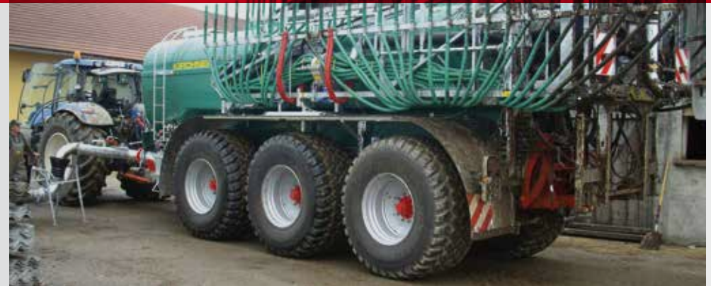
Tridem-Pump-Polyesterfass mit gelenkten und hydraulisch gefederten Achsen und einem 24 m Schleppschlauchverteiler mit Heckhydraulik, Bereifung 800/65R32
