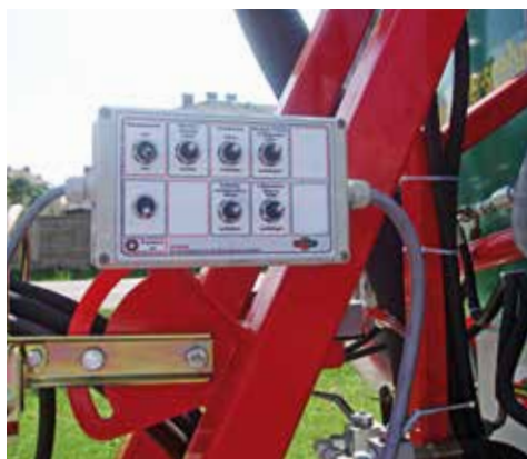
Elektrohydraulische Komfortsteuerung für sämtliche Funktionen von der Traktorkabine aus
