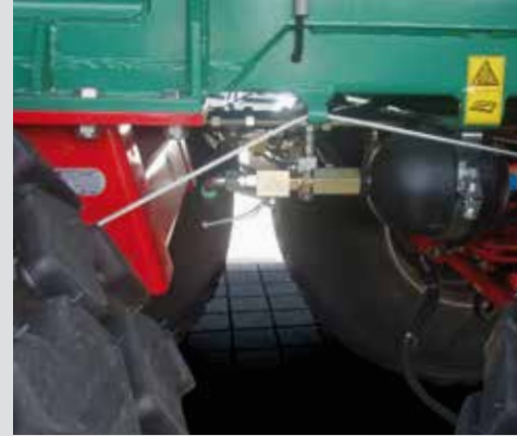
Hydraulisch gefedertes Fahrwerk mit manueller Sperrung
