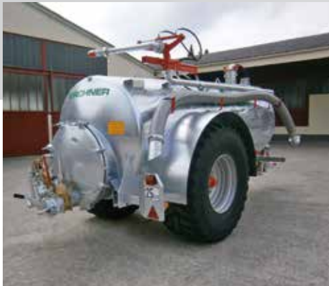
Stahlfass mit Güllewerfer und integriertem Radkasten für gekröpfte Achse mit Bereifung 750/60R30,5
