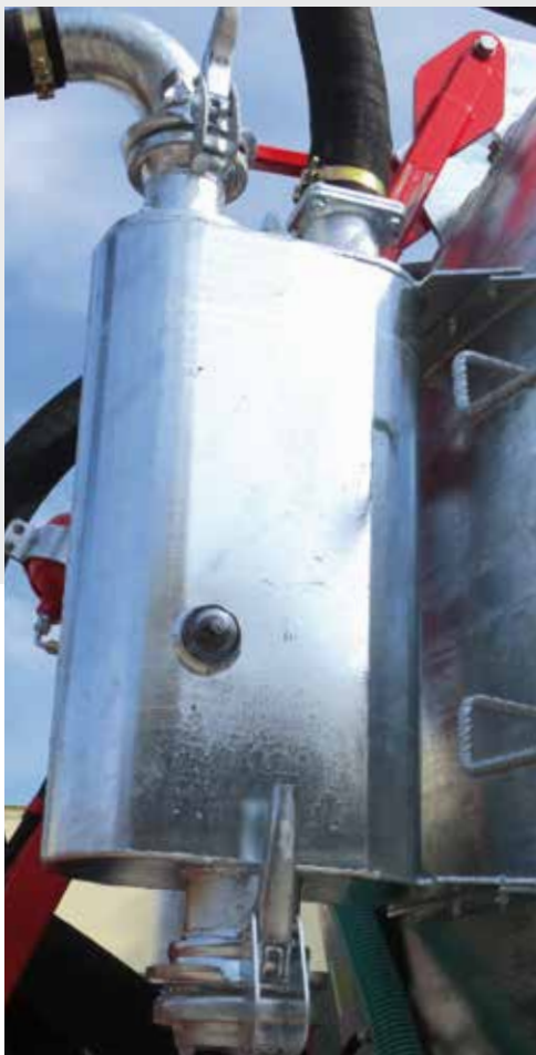
Siphon: Ausführung für leistungsstarke Vakuumpumpen
