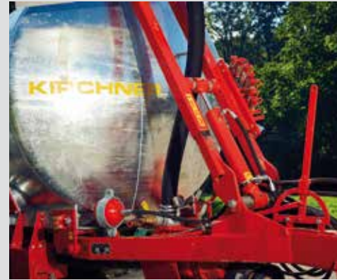
Hydraulische Deichselverstellung mit integrierter Federung. (Für alle Kirchner Modelle erhältlich)
