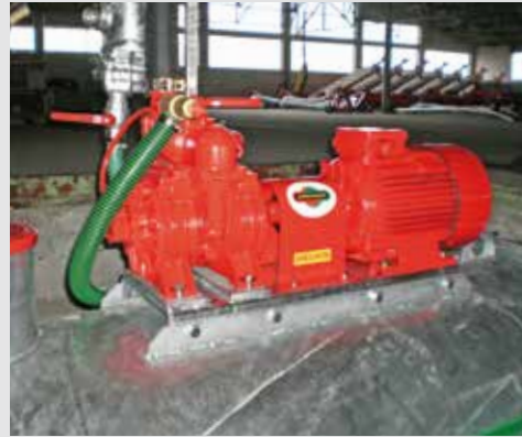
Ein elektrischer Antrieb für den Kompressor ermöglicht einen stationären Betrieb ohne Schlepper
